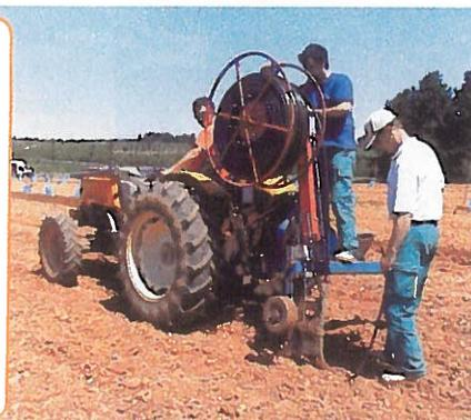
Le goutte-à-goutte enterré peut s'installer en utilisant une dérouleuse qui ouvre le sol, déroule et rebouche la tranchée.
