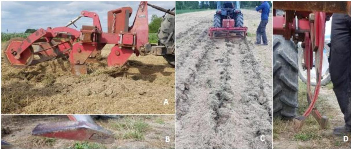
Figure 3 : Dents Michel au moment du travail de sol avant plantation (Crédit : Zélie Dupont). A : Dents Michel attelées ; B : Dents situées dans la machine ; C : Planche après le passage des dents Michel ; D : Dents situées sur les côtés de l'outil.
