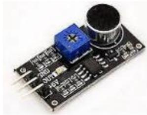
Le « micro bleu » qui est un module de moins bonne qualité pour Arduino. Il est composé d'un microphone électret d'un amplificateur dont le gain est ajustable via un potentiomètre.
