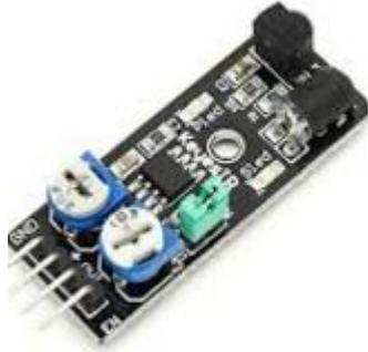
Capteur du commerce installé sur les CapTrap 2016. Il envoie un signal IR à une fréquence de 38kHz, le signal est reçu par le récepteur uniquement si un objet se trouve suffisamment proche. Il est possible de régler cette distance grâce à l'un des deux potentiomètres.
