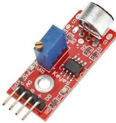
Le « micro rouge » qui est un module dit « haute sensibilité » pour Arduino. Il est composé d'un microphone électret d'un amplificateur dont le gain est ajustable via un potentiomètre 25 tours (plus précis).
