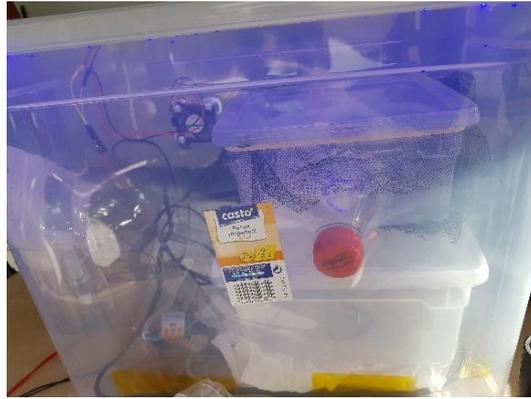
Figure 2 : Boite contenant un ventilateur, une sonde de température ainsi qu'un éclairage réglable permettant la conservation des papillons
